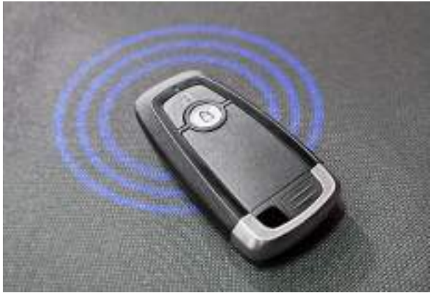
FORD KEYFREE - centralny zamek z kluczem elektronicznym Opcja dla wszystkich wersji
