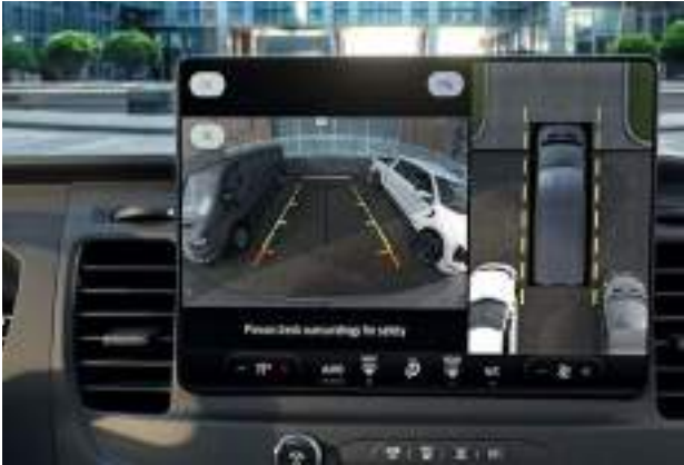
SYSTEM KAMER 360 STOPNI Wyposażenie standardowe wersji Limited. Dla wersji Trend wyposażenie standardowe serii 425, 470 i 500 Dla pozostałych wersji opcja dostępna w pakiecie Driver Assistance 6P
